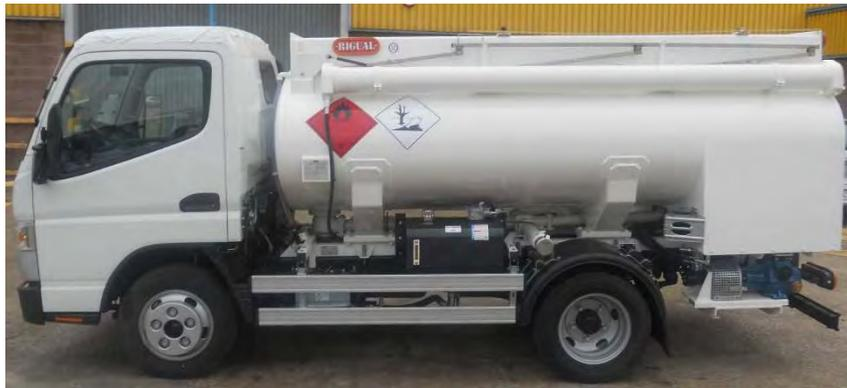
Bomba de aspiración - impulsión del producto, devanadera con manguera de aspiración y lanza (s) para la recogida de los aceites
