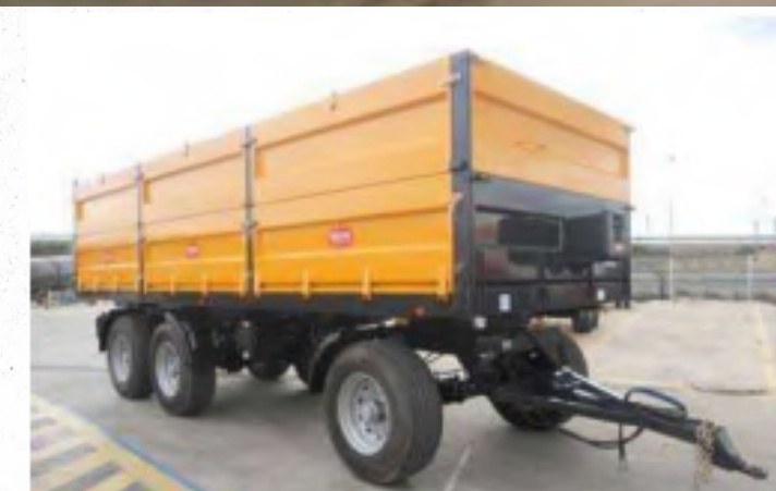
Modelo DEH-13 con 3 laterales, alzas. Sistema tándem y giratoria delantera.
