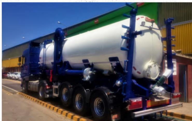
EL APLICADOR MODELO ECO 6/20 ESTÁ INTEGRAMENTE DISEÑADO POR EL DEPARTAMENTO DE I+D+I DE RIGUAL. EL MODELO ECO 6/20 TIENE UN ANCHO DE TRABAJO DE 6 METROS Y 20 SALIDAS, SE MONTA FIJO EN EL FONDO DE LA CISTERNA Y EL CHASIS DEL CAMIÓN. COMO OPCIONALES SE PUEDE AÑADIR UN ALARGO DE 300MM EN LOS EXTREMOS Y TAPONES DE LABOR 220/8.
