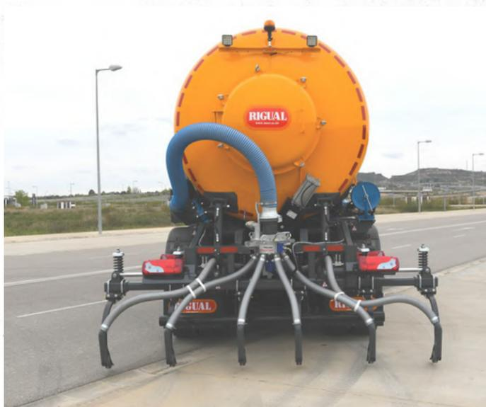
CULTIVADOR EXTENSIBLE DE 6 REJAS EQUIPADO CON TRITURADOR/DISTRIBUIDOR PARA EL ENTIERRO DEL PURÍN A PROFUNDIDADES DE 150 A 200 MM. ANCHO DE TRABAJO DE 3,3 METROS. SISTEMA DE CIERRE COMPACTO. POSIBILIDAD DE MONTAJE OPCIONAL DE DOSIMAT.
