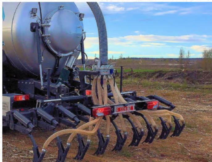
CULTIVADOR INYECTOR PLG-9, PLEGABLE DE 9 REJAS Y LONGITUD DE 4,2 METROS, DIAMETRO DE LAS SALIDAS DE 60 MM, EQUIPADA CON TRITURADOR/DISTRIBUIDOR Y PARACHOQUES EXTENSIBLE DE ACCIONAMIENTO HIDRAULICO PARA UNA APLICACIÓN DEL PURÍN A UNA PROFUNDIDAD DE 150 A 200MM.
