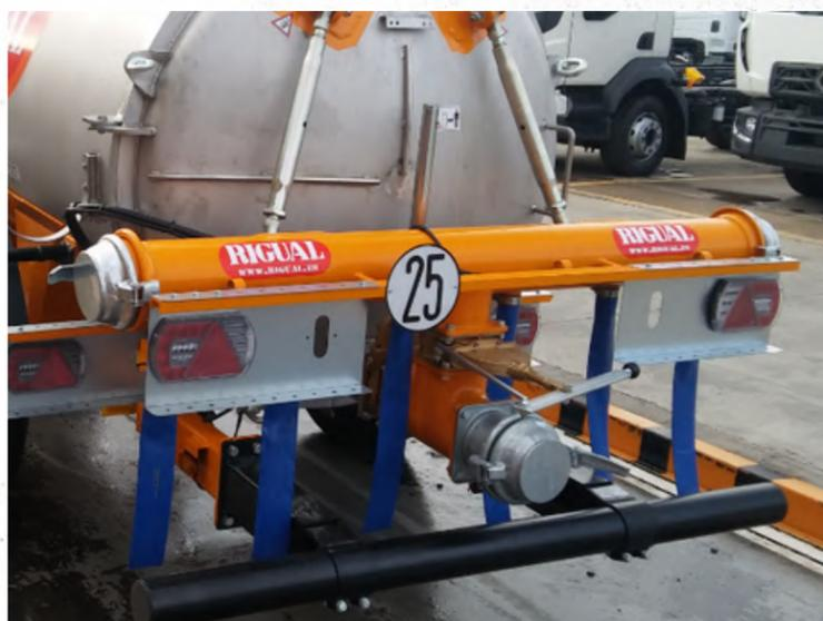
EL MODELO ECO 220/8 TIENE UN ANCHO DE TRABAJO DE 2 METROS Y 8 SALIDAS, SE MONTA FIJO EN EL FONDO DE LA CISTERNA. COMO OPCIONALES SE PUEDE AÑADIR UN ALARGO DE 300MM Y TAPONES DE LABOR 220/8.
