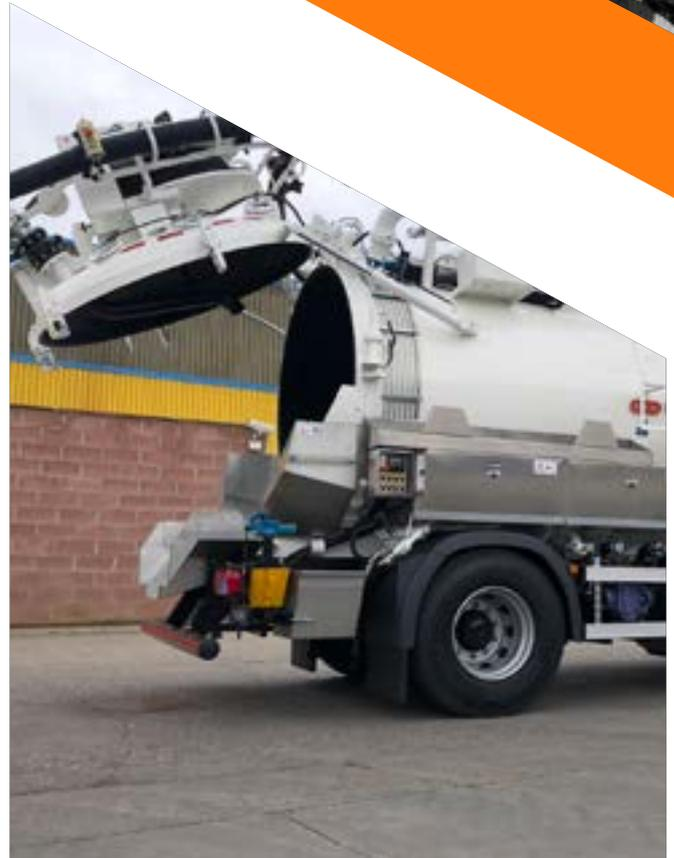
Este tipo de cisternas están diseñadas para realizar tanto trabajos de impulsión como de aspiración. La cisterna se divide en dos compartimientos cuyas capacidades define el cliente en función de su tipología de trabajo.
